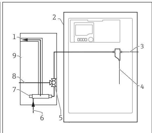
■ 4 Измерительная система с Liquiline System CAT810 с очистным клапаном
